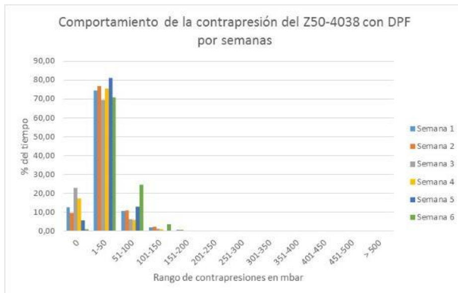
Figura 3. Comportamiento de la contrapresión de los gases de escape en las 6 primeras semanas de operación
