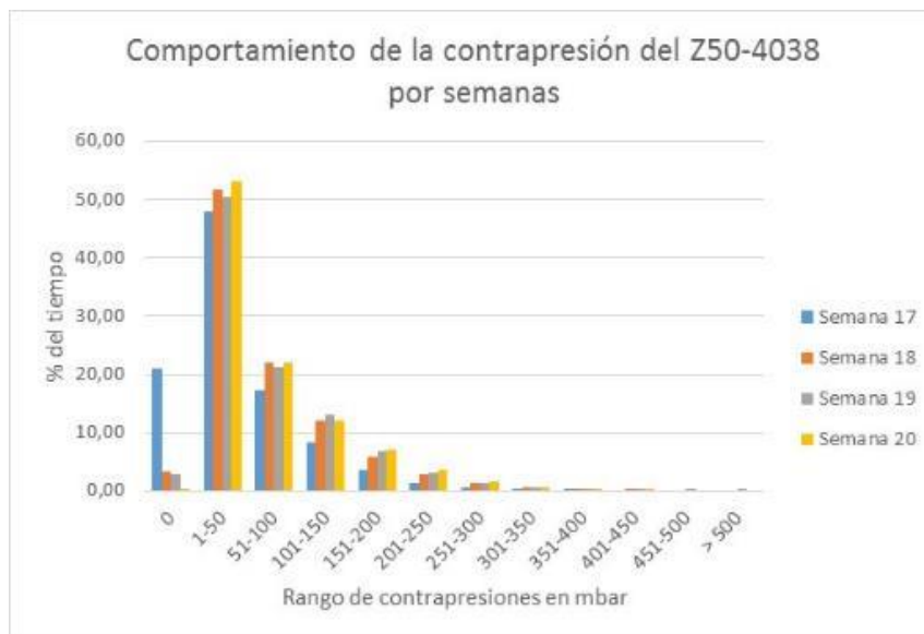
Figura 6. Comportamiento de la contrapresión de los gases de escape en las semanas 17 a 20 de operación
