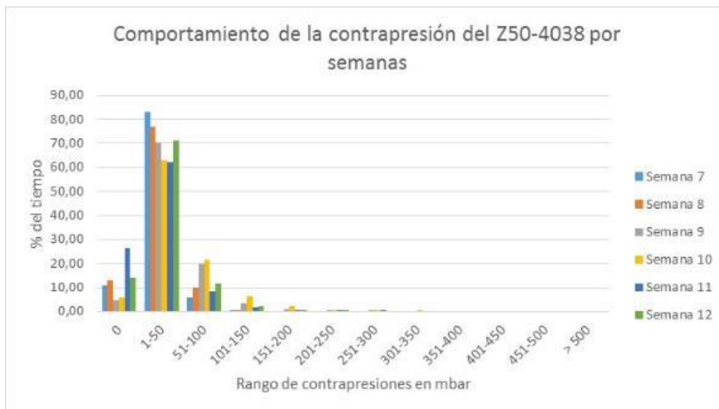
Figura 4. Comportamiento de la contrapresión de los gases de escape desde la semana 7 a la 12 Fuente: Información entregada por Diésel y Turbos. Consolida SCAAV
