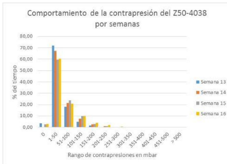
Figura 5. Comportamiento de la contrapresión de los gases de escape en las semanas 13 a 16 de operación
