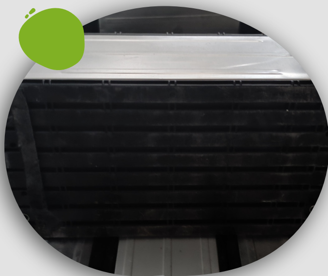
Ilustración 3. Empaquetamiento de geometría tipo bolsa. Fuente: Recobatt S. A. S.
