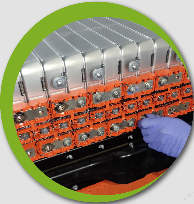
Ilustración 2. Empaquetamiento de geometría prismática. Fuente: Recobatt S. A. S.
